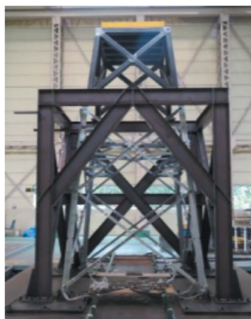
図1 鉄塔の部分模型を用いた振動台実験
